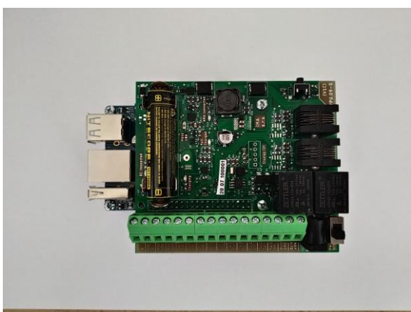
Řídící elektronika pro komunikaci GVM.01 – vydavač golfových míčků – platební terminál - banka
